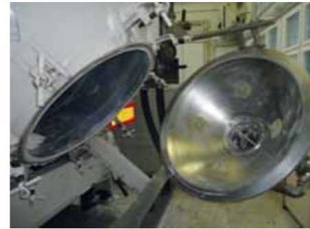
Im Bild der gereinigte Zellen-Auslauf. Neue Systeme verfügen zur Fluidisierung einfach zu reinigende Düsen und nicht mehr über Tücher.
